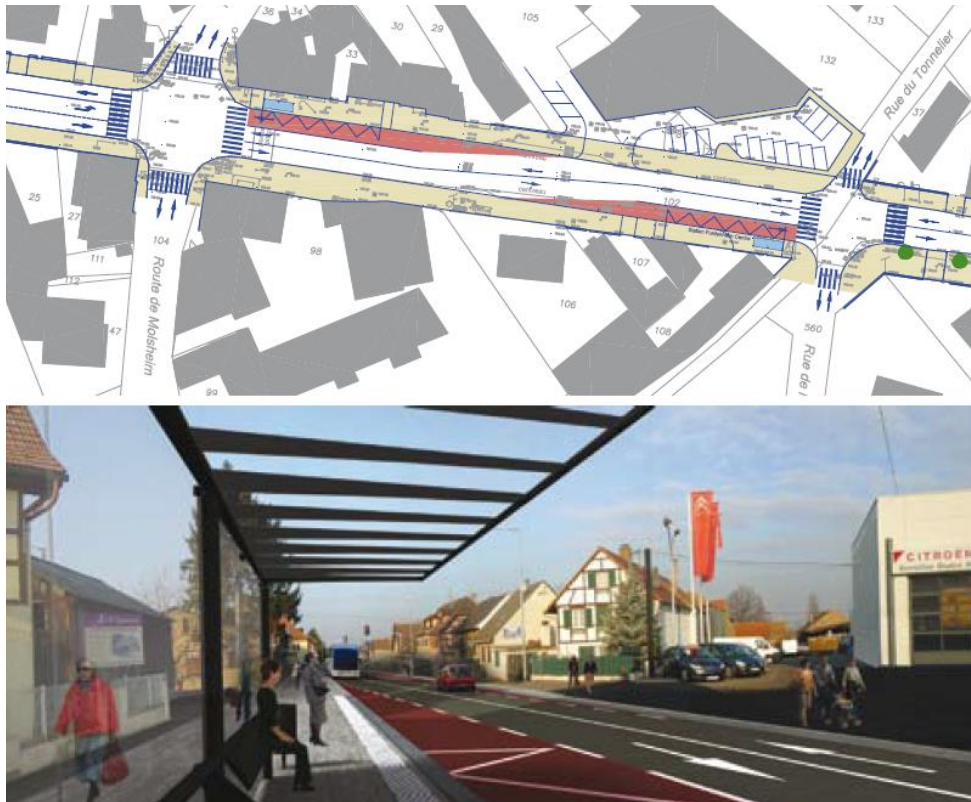
Figure 7 : Principe d'aménagement dans la traversée d'une agglomération (source : Conseil Général du Bas-Rhin)
